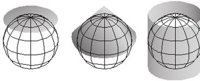
Figura 11: Representación simplificada de proyección planar, cónica y cilíndrica
